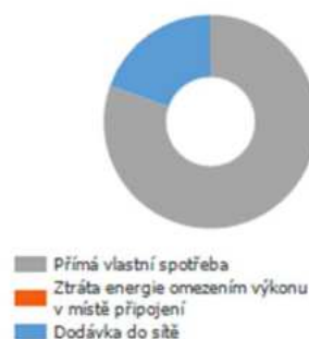
Energetický výnos FVS (AC síť) s baterií
