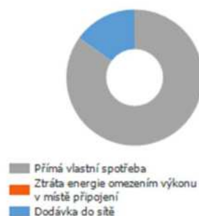
Energetický výnos FVS (AC síť) s baterií
